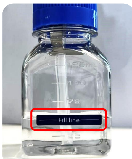
Rysunek 22.2 Kreska wskazująca prawidłowy poziom wody w butli do nawilżania
