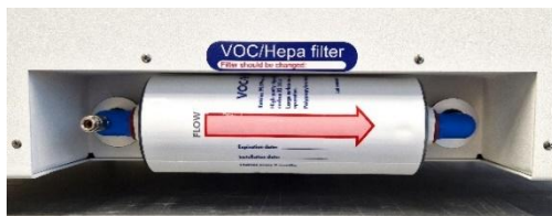
Rysunek 12.3 Prawidłowo zamontowany filtr LZO/HEPA
