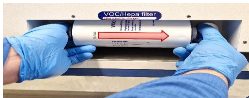
Rysunek 12.2 Procedura montażu i demontażu filtra LZO/HEPA
